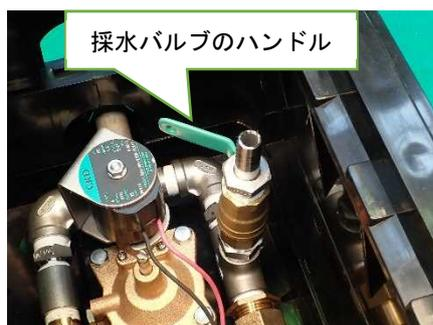
⚠️ コントローラボックスを取り出す際、ボックス本体やケーブルなどが採水バルブのハンドルに引っかからないよう、注意してください。ハンドルに引っかかったことに気付かずコントローラボックスを取り出すと、採水バルブから水が噴き出します。
