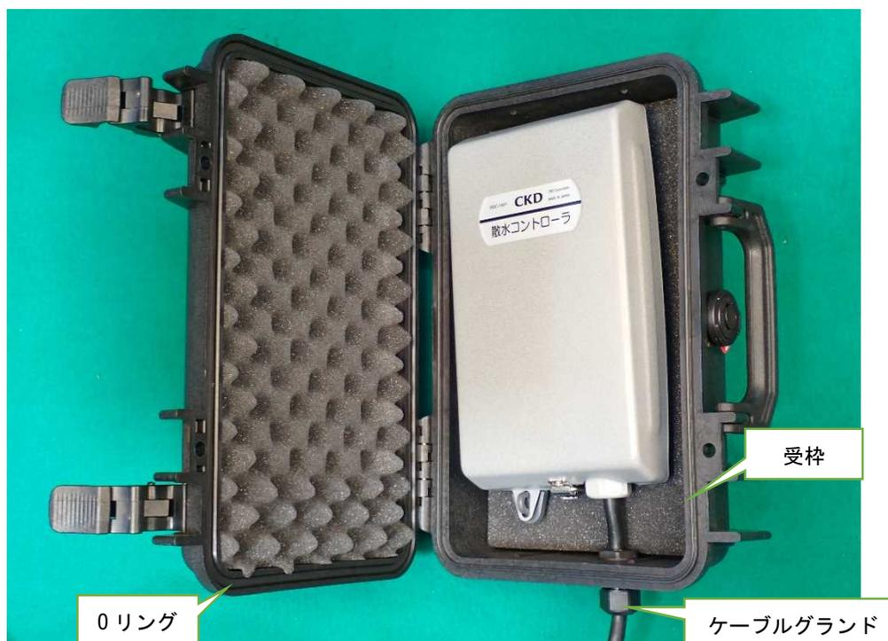
⚠️作業終了時はコントローラボックスを閉じる前に必ず、ケーブルグラウンドの確認とOリングおよび受枠の清掃を行ってください。正しく行わない場合、IP67の防水性が損なわれる恐れがあります。
